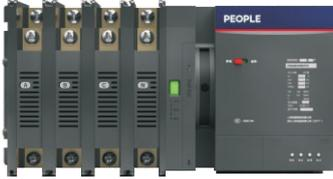
RDQ5系列双电源自动转换开关（以下简称双电源），它适用于交流50Hz、额定工作电压400V、额定工作电流125A及以下的供电系统。可根据需求或具体电路情况进行两路电源之间的切换选择。本产品具有过压、欠压、缺相保护功能，同时还具备消防、双分和输出合闸信号功能。产品适用于高层楼宇、商场、银行、医疗卫生等不允许停电的重要场所。
