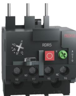
RDR5系列双金属片式热过载继电器(以下简称热继电器)主要用于交流50、60Hz, 额定工作电压 $U_e$ : 690V, 额定冲击耐受电压 $U_{imp}(kV)$ :8, 额定电流0.1~93(A)电路中, 作电路和电动机的过载、断相、保护之用。热继电器具有断相保护、温度补偿、整定电流调节、自动复位和手动复位任意选择、动作指示信号、动合、动断辅助触头绝缘分开、安装面积小、安装方式多样等功能特点, 具有测试按钮和停止按钮。可进行动作灵活性检查。有防止手指触电护罩, 使用安全。有闭锁装置防止误操作等。
