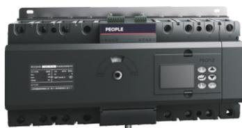
RDQH5系列双电源自动转换开关主要用于交流50/60Hz，额定工作电压400V，额定工作电流16A至630A的电力系统中。产品常用、备用端进线可接两路电网电源或一路电网一路发电机电源。当一路电源异常（断相、过压、欠压）时，产品自动切换至另一路正常电源，以保障负载不间断供电。主要应用于高层建筑、商场、银行、医院、机场等不允许停电的重要场所。同时，产品具有短路保护、过载保护，以保证供电的可靠性和安全性。
