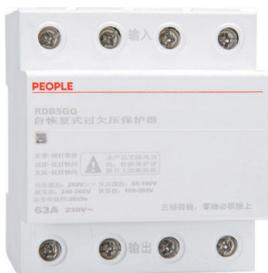
RDB5GQ自恢复式过欠压保护器是新型智能保护电器主要适用于交流电压230/400V，频率50Hz，额定工作电流80A及以下的用户或负载，主要用于住宅分户箱或其他需要保护的配电线路中，产品采用模数化标准设计，当供由线路出现过电压，欠电压时，保护器能迅速、安全地切断电源，避免异常电压送入终端电器造成事故的发生，当电压恢复正常值，保护器将在规定时间内自动接通电路，确保终端电器在无人值守情况下正常运行。
