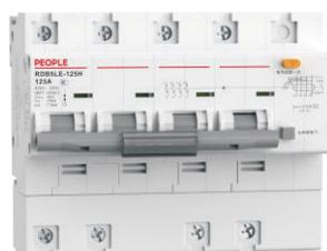
RDB5LE-125H系列漏电断路器，用于交流50Hz或60Hz、额定电压单级两线(1P+N)、两级(2P)230V；三级(3P)、三级四线(3P+N)、四级(4P)400V，额定电流从80A到125A的线路中，对人体提供直接或间接的接触保护，也可用来防止因设备绝缘损坏，产生接地故障电流而引起的火灾危险。并可用来保护线路过载及短路，亦可作为线路的不频繁转换之用及电动机的不频繁启动之用。该系列产品具有分断能力高、体积小、重量轻、部件通用性强、外形美观等优点，导轨安装，使用方便。
