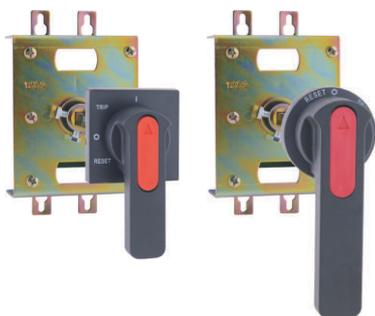
旋转手柄根据人体力学，采用独特的设计和传动结构，通过旋转手柄实现了塑壳断路器的合闸、分闸和再扣。操作灵活、平稳、操作力小、安装方便。
