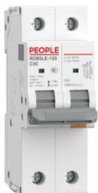
RDB5LE-100系列剩余电流动作断路器(简称漏电断路器)适用于交流50Hz、额定电压230/400V, 额定电流至80A的线路中, 作为负载线路的漏电(触电)、过载和短路保护。也可作为不频繁接通、分断和转换之用。该系列产品具有分断能力高、附件适用性强、体积小、重量轻、外形美观和使用方便等优点。
