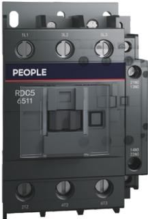
RDC5系列交流接触器主要用于交流50HZ，额定工作电压至690V，额定工作电流至95A的电路中，供远距离接通与分断电路之用，并可与热继电器直接插接组成电磁起动器，以保护可能发生操作过负荷的电路。接触器还可组装积木式辅助触头组、空气延时头、机械连锁机构等附件，组成延时接触器、可逆接触器、星三角起动器。
