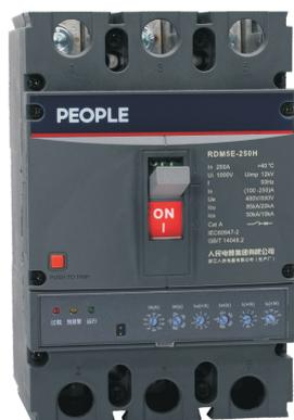
RDM5E系列电子式断路器适用于交流50Hz，额定工作电压至690V，额定电流至2000A以下的配电网中，用来分配电能和保护线路及电源设备免受过载、短路和欠电压等故障的损坏。亦能作线路不频繁转换及电动机不频繁起动之用。断路器具有过载长延时反时限、短路短延时反时限、短路短延时时限、短路瞬时和欠电压保护功能。该产品具有体积小、分断能力高、飞弧短、附件安装方便、抗震动的特点，是陆地及船舶使用的理想产品。
