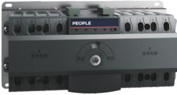
RDXQ5系列双电源自动转换开关主要用于交流50/60Hz，额定工作电压400V，额定工作电流6A至100A的电力系统中。产品常用、备用端进线可接两路电网电源或一路电网一路发电机电源。当一路电源异常（断相、过压、欠压）时，产品自动切换至另一路正常电源，以保障负载不间断供电。主要应用于高层建筑、商场、银行、医院、机场等不允许停电的重要场所。同时，产品具有短路保护、过载保护，以保证供电的可靠性和安全性。
