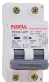
RDB5LE-63Y系列一体式剩余电流动作断路器主要用于交流50Hz，额定电压230V，额定电流至63A的线路中，作为负载线路的漏电（触电）、过载和短路保护。也可作为不频繁接通、分断和转换之用。该系列产品具有分断能力高、附件适用性强、体积小、重量轻、外形美观和使用方便等优点。
