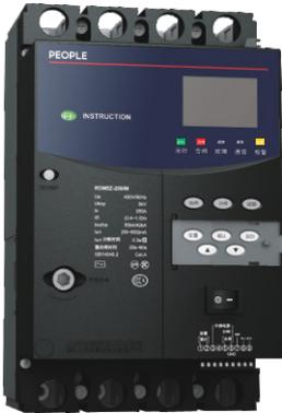
RDM5Z系列自动重合闸断路器主要用于交流50Hz，额定工作电压至400V，额定工作电流至630A的三相四线中性点直接接地的电力系统中，用来分配电能，保护线路。可用于欠电压、过电压保护（包括电源侧缺相、失压、断零）、过电流保护（具有电流感应自生电功能）、短路保护、剩余电流保护；在线实时监测显示线路中的电流、电压、剩余电流等参数；具有自动重合闸功能，线路解除故障后可自动重合。
