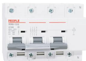
RDB5-125S小型断路器。该产品适用于交流50Hz或60Hz，额定工作电压230V/400V，额定电流为125A及以下的控制线路中对线路进行远距离控制分断及自动信号控制分断，同时对线路过载和短路的保护作用，也可在正常情况下作为线路不频繁操作转换之用。目前广泛用于单相/三相智能预付费电能表(如C卡)的配套使用，以实现控制线路的通断。该系列产品具有分断能力高、体积小、重量轻、部件通用性强、外形美观等优点标准导轨安装，使用方便。产品符合:GB/T10963.1、IEC60898-1标准。
