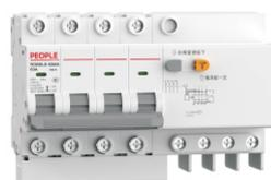
RDB5LE-63MA系列剩余电流动作断路器(下称漏电断路器)适用于交流50Hz、额定电压230/400V, 额定电流63A的线路。额定短路分断能力不超过6000A的保护配电路径中, 作为线路不频繁接通、分断和转换之用, 此系列断路器仅有漏电、短路保护功能, 无过载保护功能。同时具有强大的辅助功能模块, 如辅助触点、带报警指示触点、分励脱扣器、欠压脱扣器、远程脱扣控制等模块。
