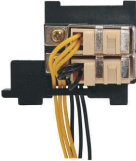
辅助触头安装在断路器上，它与断路器操作机构的分、合联动，辅助触头可用于断路器分、合状态的监视，以及通过控制电路连接，实现对其相关的电器实施控制或联锁，如向信号灯、继电器等输出信号。断路器处于分闸或自由脱扣状态时，F12(F22)和F11(F21)接通，F14(F24)和F11(F21)断开；断路器处于合闸状态时，F12(F22)和F11(F21)断开，F14(F24)和F11(F21)接通。
