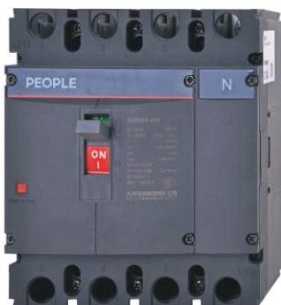
RDHM5系列隔离开关(以下简称开关)。适用于交流50Hz/60Hz额定电压690V及以下, 额定电流至800A的电路中, 主要用于通断电阻性负载, 包括适当过负载, 作线路与电源隔离之用。尤其适合线路检修时有效隔离电源并防止意外合闸, 以确保检修人员的操作安全。
