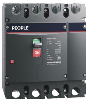
RDM5系列塑料外壳式断路器主要用于交流50Hz，额定绝缘电压1000V，额定工作电压690V及以下，额定电流至2000A以下的配电网络中，用来分配电能和保护线路及电源设备免受过载、短路和欠电压等故障的损坏。其中额定电流630A及以下的断路器亦可作为保护电动机之用正常情况下，断路器可分别作为线路的不频繁转换及电动机的不频繁起动之用。断路器具有隔离功能，采用符号“ $\text{—} \text{I} \times \text{—}$ ”表示。
