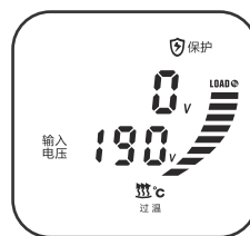
过温保护：当机器温度超过110°C时，机器停止输出。
