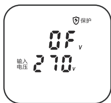
继电器保护：当继电器故障时机器停止输出。
