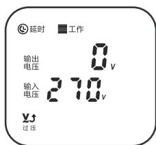
过压：当输出电压超过250V时，机器停止输出。
