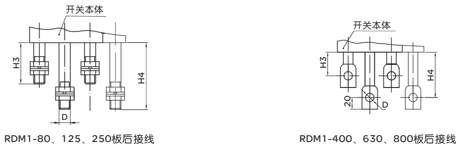
图8 RDM1系列板后接线外形及安装尺寸
