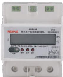
DDSU858型系列单相电子式电能表，广泛用于计量居民住宅、机关、商店等的照明、家电等用电量。该表采用先进的超低功耗集成电路技术和SMT制造工艺，用以计量额定电压220V、额定频率为50Hz/60Hz的交流单相有功电能。
