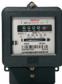
DD862-4单相电能表是直接接入式感应式电度表，用于测量50Hz交流电路中的有功电能，该产品符合国家标准GB/T17215.311-2008 idtEC521:1998 行业标准JB/T5467-1997对2级表的要求。
